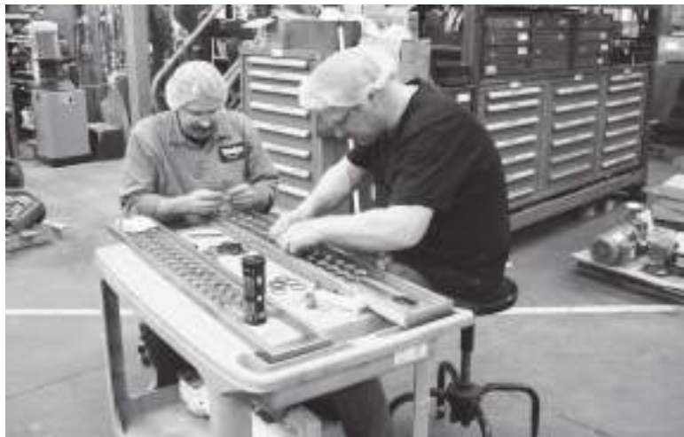
Tjeerd vervangt afdichtingen in een draaimatrijs bij Hersheys in de VS. (eigen foto)
