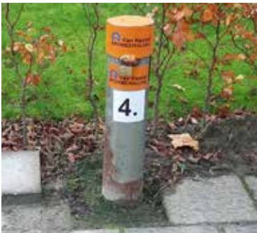
Een van de paaltjes die de grondwaterstand meten (foto: Johan Kootstra)
